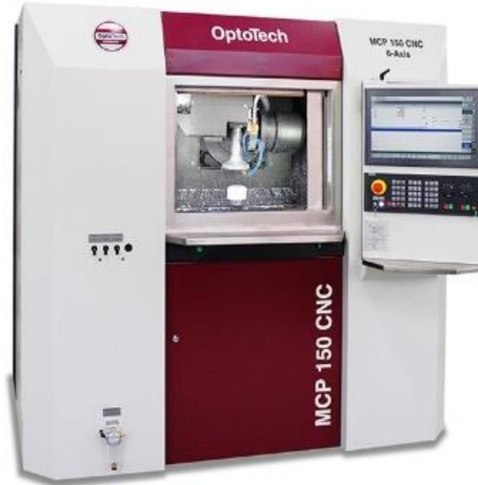
Der A-WPT –Prozess bei der Annäherung an den Startpunkt der Werkzeugbahn (links) und das 6-achsige Polierzentrum MCP 150 CNC (rechts).
